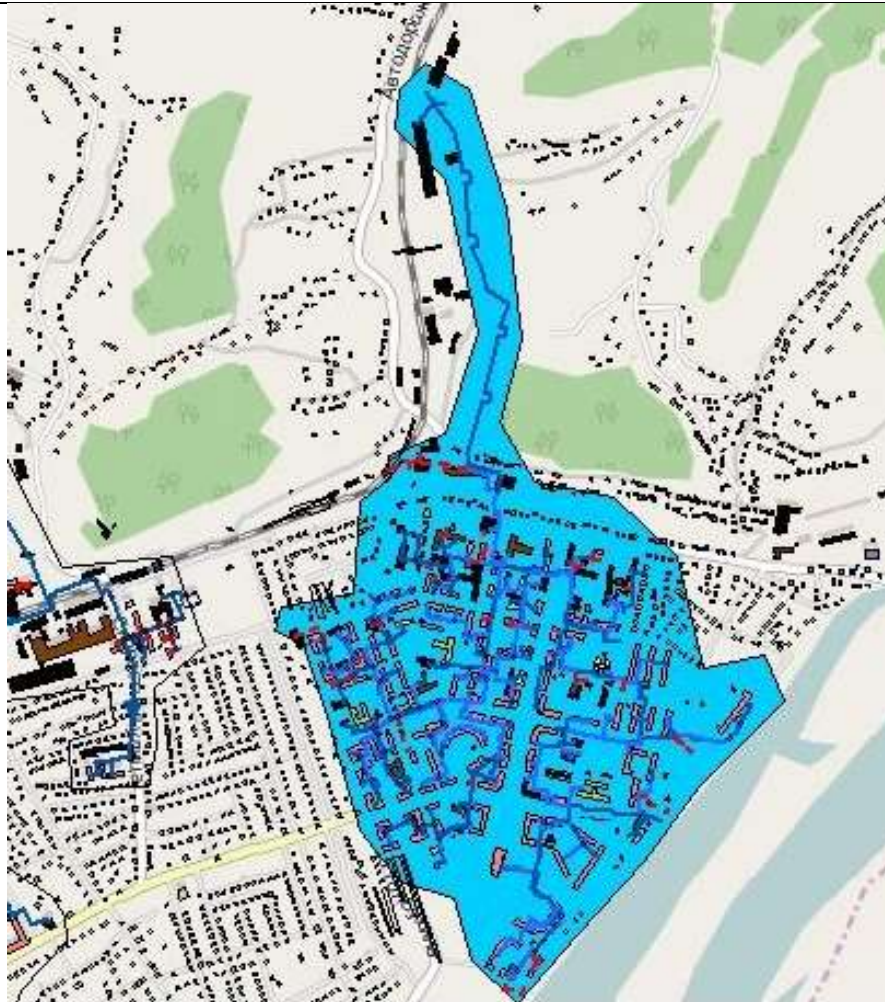
Рисунок 5 - Зона действия котельной АРК
